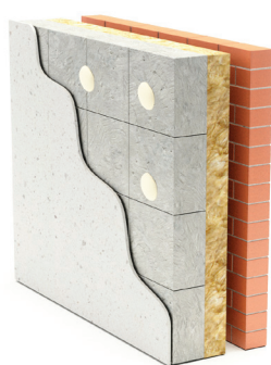
Partial fill cavity
